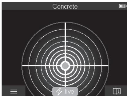
ใน <Spot View> ผลการวัดจะปรากฏขึ้นโดยไม่ต้องเคลื่อนเครื่องมือวัดไปที่พื้นดังนั้น จึงเหมาะสมอย่างยิ่งสำหรับการวัดในมุมหรือในพื้นที่แคบ ความลึกสูงสุดในการวัดคือ 6 ซม. จะแสดงคุณสมบัติของวัสดุดูถูกที่ตรวจพบ และในเมื่อข้อมูลชิงลึก เมื่อได้ค่าตามทักษะเป็นไปได้ คุณควรเคลื่อนเครื่องมือวัดใน <Spot View> เท nostro พื้น เพื่อให้ได้ผลการวัดที่ดีที่สุด หากไม่เคลื่อนเครื่องมือวัด จะมีข้อจำกัดในการตรวจจับตำแหน่งท่อพลาสติกและคานไม้เป็นพิเศษ
