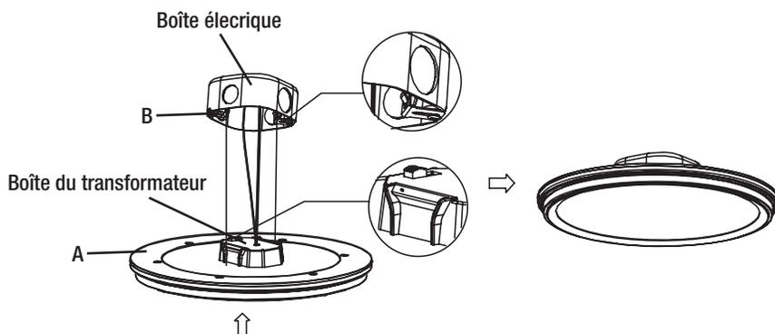
**9** Tournez la lampe de façon à ce que la boîte du transformateur s'aligne avec le support de montage dans la boîte électrique, puis enclenchez la lampe sur le support de montage. Assurez-vous que la lampe tienne solidement.
