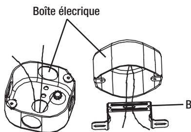
**4** Enroulez le fil de terre de la boîte électrique autour de la vis de terre ou couvrez-le d'un serre-fils.
