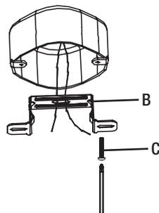
**6** Utilisez les vis pour fixer le support de montage à la boîte électrique.
