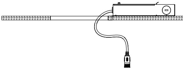
**6** Placez la boîte électrique (B) à travers le trou découpé dans le plafond et placez-la où désiré.
