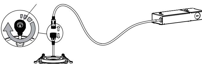
**2** Desserrez les connexions rapides dans le sens des aiguilles d'une montre et détachez le corps de l'appareil de la boîte de jonction.
