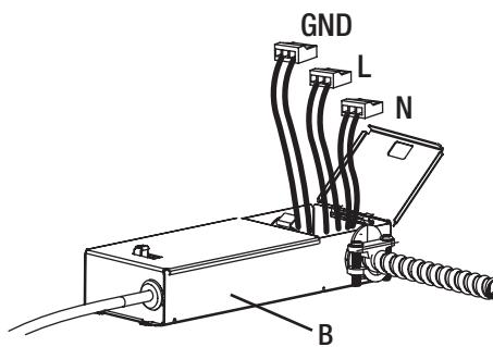
**5** Alimentez les fils de la source électrique à travers le trou ouvert knock out dans le boîte électrique (B). Insérez les fils chauds et neutres de la source électrique dans le connecteurs métalliques des fils noirs et blancs dans la boîte électrique (B). Insérez le fil de sol de la source électrique dans les connecteurs métalliques du vert fil dans la boîte électrique (B). Fermez le couvercle de la boîte électrique.
