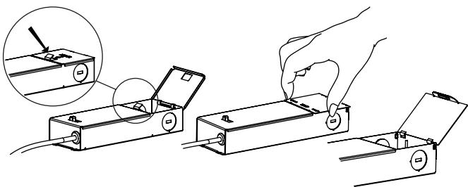
**3** Appuyez sur le ressort pour ouvrir le couvercle de la boîte électrique (B). Prenez la couverture de la boîte de conducteur d'où pointe la flèche « OPEN ».
