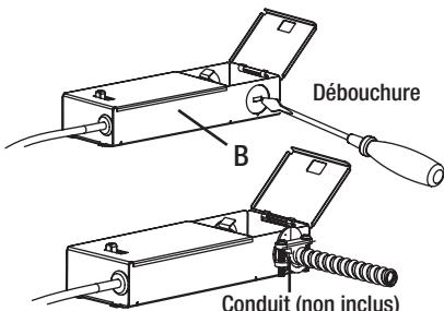
**4** Retirez l'un des trous knock out sur le côté de la boîte électrique (B), en fonction de la position d'installation. Alimentez le conduit (non inclus) et tous les fils de raccordement électrique à travers le trou à élimination directe ouvert dans la boîte électrique et serrez le conduit solidement.
